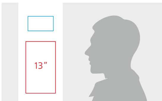
Sotto il display del piano e della direzione della corsa, è possibile fornire informazioni in formato verticale (risoluzione 1080 x 1920 px) da 13" in base alle proprie esigenze.
