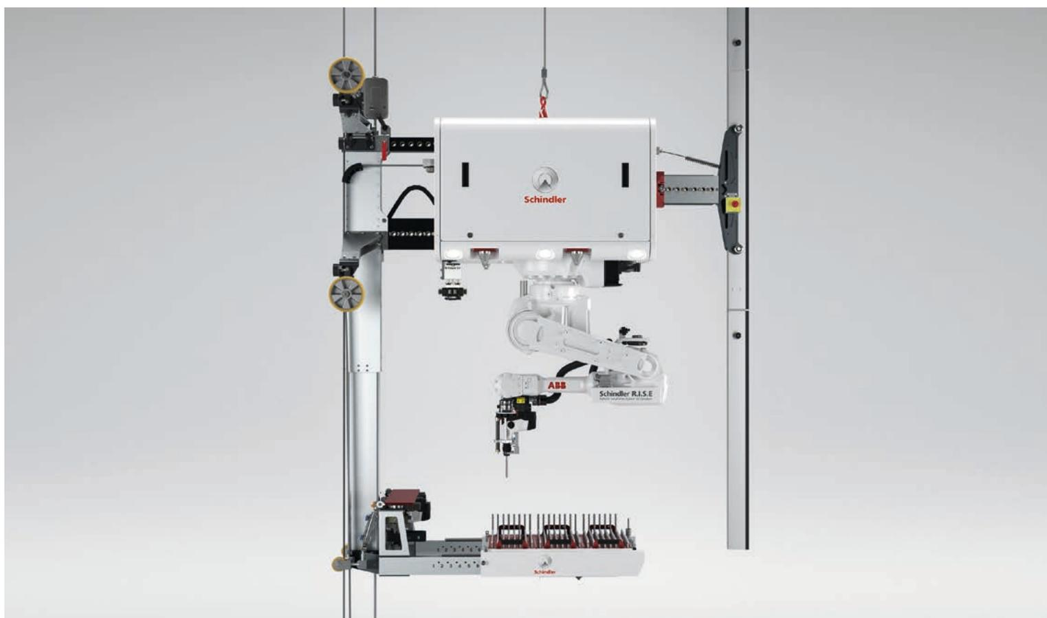
Schindler R.I.S.E. pose les boulons d'ancrage avec persévérance et précision (à gauche). Grâce à un système de treuil, le système peut se déplacer tout seul dans la gaine d'ascenseur (en bas à gauche).
