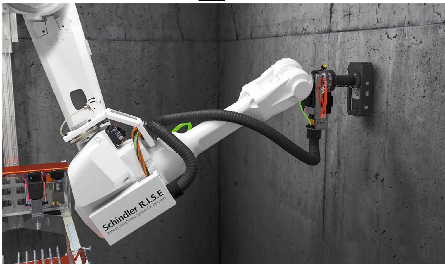
Avec Schindler R.I.S.E., les ascenseurs Schindler prennent encore plus de hauteur. Le système robotisé facilite le montage d'ascenseurs en prenant en charge les travaux de perçage ardu dans la gaine. En particulier dans les projets de grande envergure, la sécurité et l'efficacité peuvent être encore améliorées.
