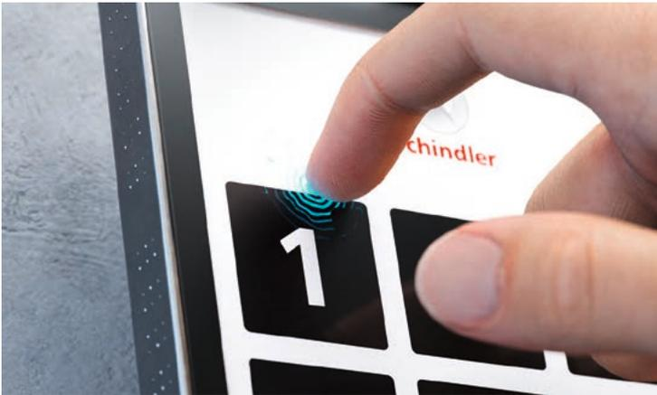
Wichtig sind aber vor allem haptische und akustische Rückmeldungen. Die Oberfläche des Panels erkennt aufgrund der individuellen Bedienung, ob eine zusätzliche Orientierung nötig ist: Fährt jemand mit dem Finger suchend über die Anzeige, schaltet das Display auf fühlbare Tastenbegrenzungen, Töne und sprachliche Rückmeldungen um. Trifft der Finger eine Taste, wird keine Aktion ausgelöst, sondern die Taste reagiert mit leichten Vibrationen und einem akustischen Signal.
