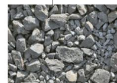
En construisant avec du béton recyclé, on fait d'une pierre plusieurs coups. D'une part, le recyclage des matériaux de démolition permet de ménager de précieux gisements de gravier et de les préserver pour l'avenir. D'autre part, un espace de décharge tout aussi précieux peut être
